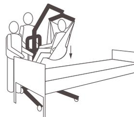
Abbassare il paziente in modo che i piedi poggino sulla base del sollevatore, ai due lati dell'albero.
